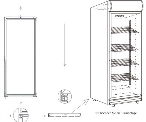
5. Setzen Sie das rechte obere Türscharnier in das linke untere Türscharnier ein. 9. Setzen Sie das untere Frontgitter wieder ein.
