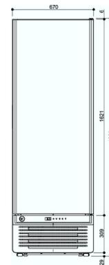
Klimaklasse 3: Dieses Gerät ist nicht für den Gebrauch bei Umgebungstemperaturen über 25 °C bestimmt und daher nicht für die Verwendung in heißen gewerblichen Küchen geeignet.
